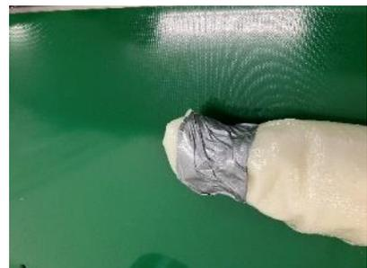
4. Verschlossenes BRAWOLINER<sup>®</sup> Ende in Kunststoffbeutel packen. Kabelbinder mit Klebeband umwickeln.
