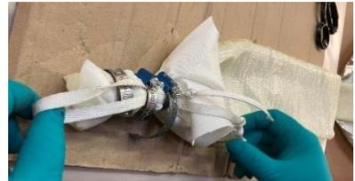
6. Das verschlossene Linierende mit durchsichtigem Klebeband umwickeln.
